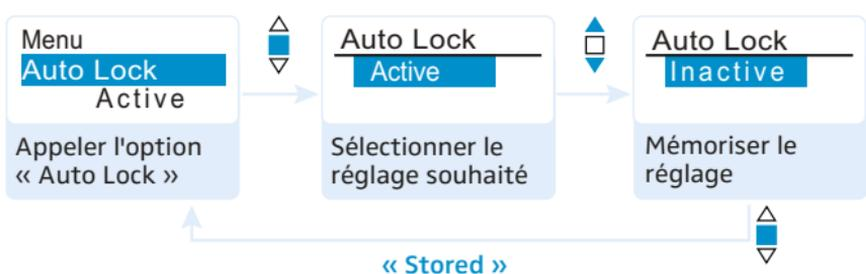
Le verrouillage des touches évite que l'émetteur à main soit désactivé involontairement pendant le fonctionnement ou que des modifications soient effectuées. Le symbole d'activation du verrouillage des touches (🔒) dans l'affichage standard actuel indique que le verrouillage des touches est activé.
