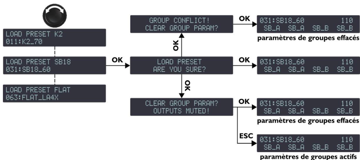
Figure 26 : Charger un preset (exemple d'un preset usine)
