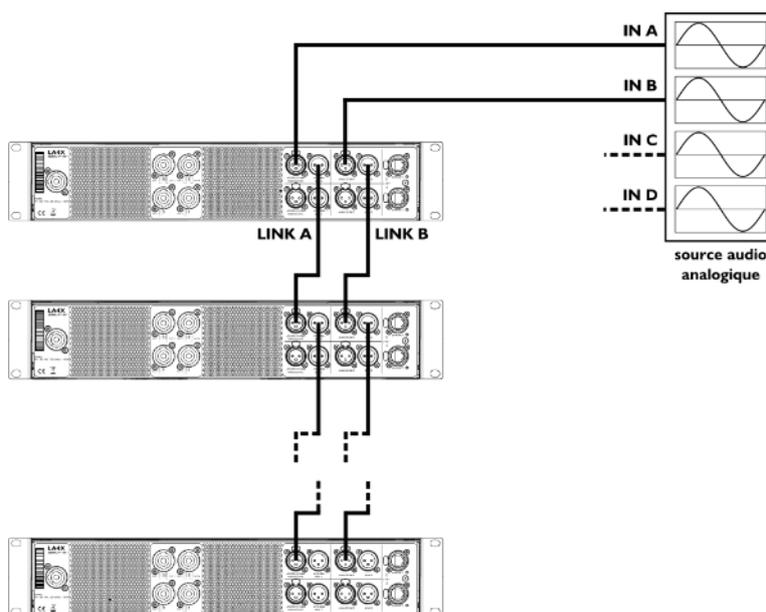
**Figure 8 : Câblage audio analogique en cascade**
