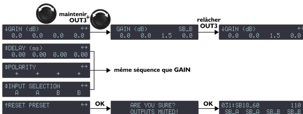
**Figure 30 : Régler les paramètres de preset**
