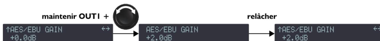
Figure 37 : Réglage du gain AES/EBU
