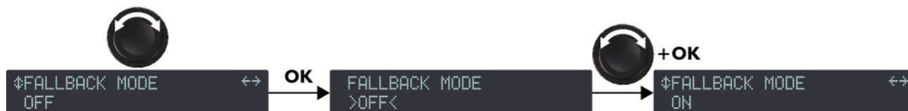
**Figure 36 : Sélectionner le mode de basculement**
