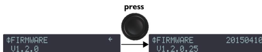
**Figure 39 : Afficher le numéro de version entier et la date de compilation du firmware**
