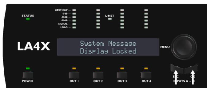
Figure 17 : Verrouillage du panneau avant
