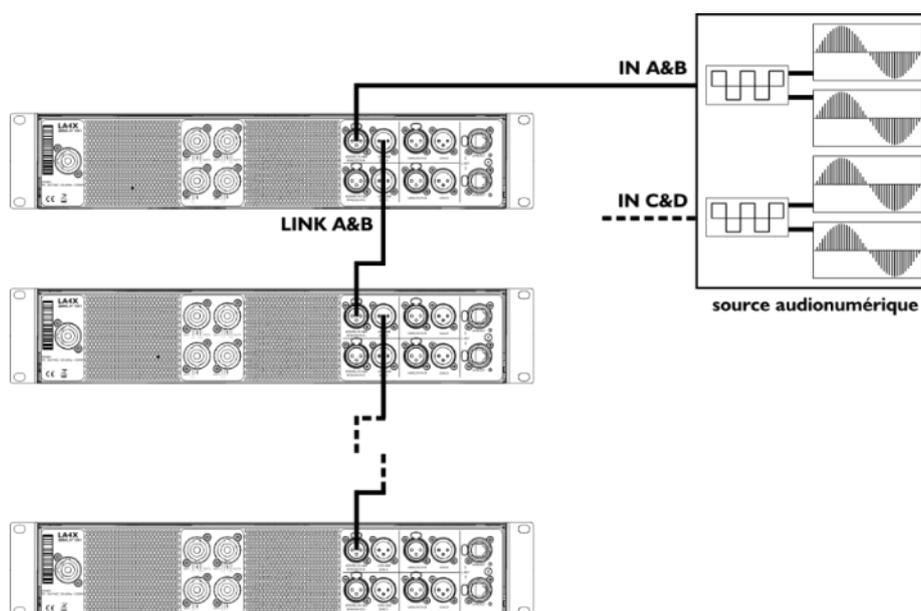
**Figure 9 : Câblage audionumérique en cascade**
