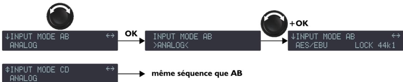
**Figure 32 : Sélectionner le mode d'entrée**
